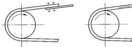
图 5.7.2-2 平带搭接方向与带轮转向
