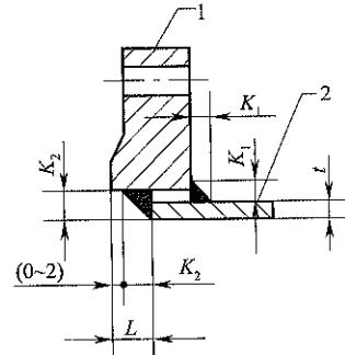
图 6.2.2-2 管子插入法兰的焊接
