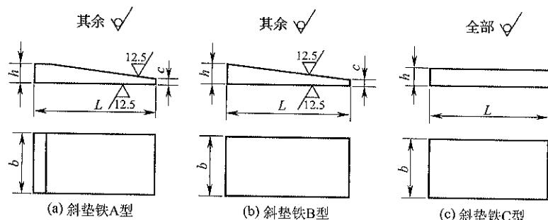
图 A.0.2 斜垫铁和平垫铁
