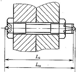
图 5.2.4-1 紧固后的螺栓
