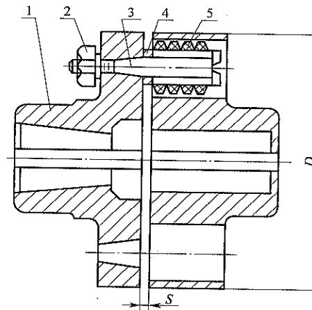
图 5.3.12 弹性套柱销联轴器
