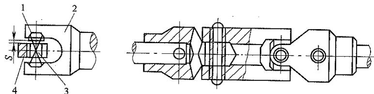
图 5.3.8 十字轴式万向联轴器
