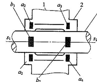
图 5.5.4 压铅法测量轴承顶间隙
