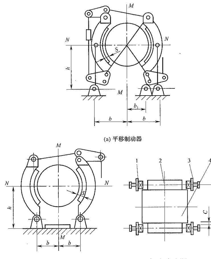
图 5.4.8 瓦块式制动器
