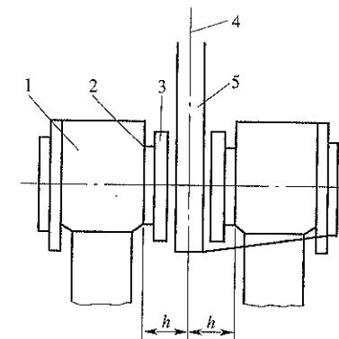
图 5.4.7-1 支架端面与制动盘中心平面间距
