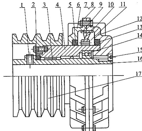
图 5.3.15 V带轮钢砂式安全联轴器
