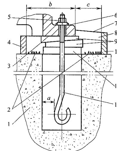
图4.1.1 安设预留孔中的地脚螺栓
