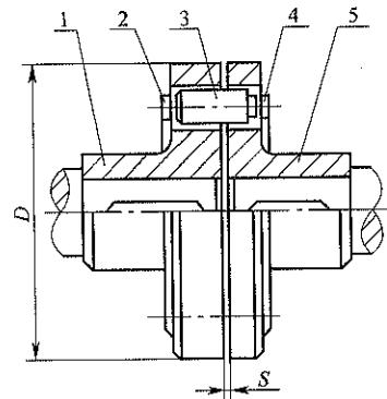
图 5.3.13 弹性柱销联轴器
