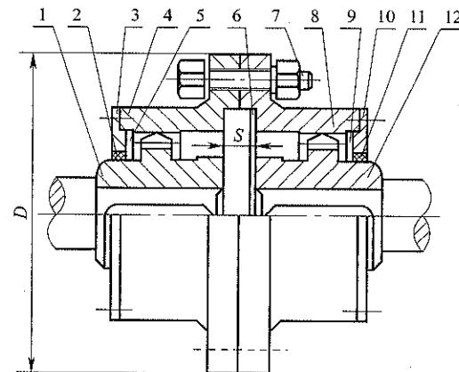
图 5.3.6 齿式联轴器
